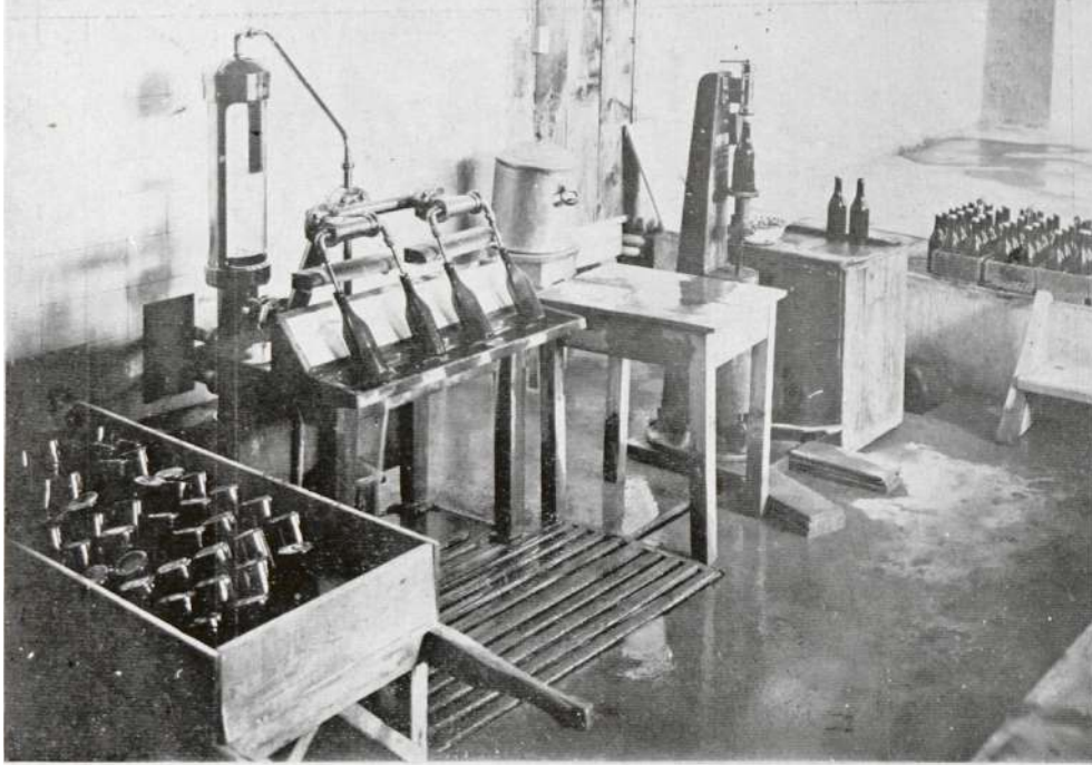
▲ Görsel 58: 1930'lu yıllarda Kızılây tesislerinde kullanılan dörtlü şişe doldurma sistemi ve tek tek kapak takan makine.
