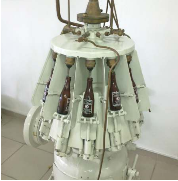
◀ Görsel 69: 1950'li yıllarda Kızıl意思ay Karahisar Maden Suyu tesislerinde de otomatik şişe doldurma ve kapak takma makineleri çalışmaya başlamıştı.
