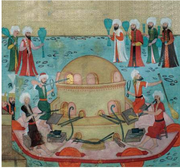
▲ Görsel 8: 1550'de, Sultan III. Murat döneminde yapılmış minyatürde İstanbul'daki camcılar geçit töreninde; araba üzerinde cam fırını, el aletleri ve ustaların çalışma düzeni.
