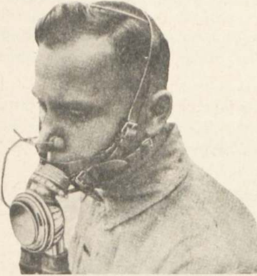
8 — Oksijen cihazı ile maske yerine kullanılabilen ağızlık.
