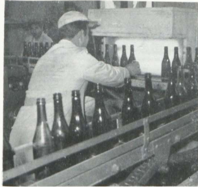
Otomatik şekilde el değmeden dolan şişeler kuvvetli ışık önünde tek tek kontrol edilir.
