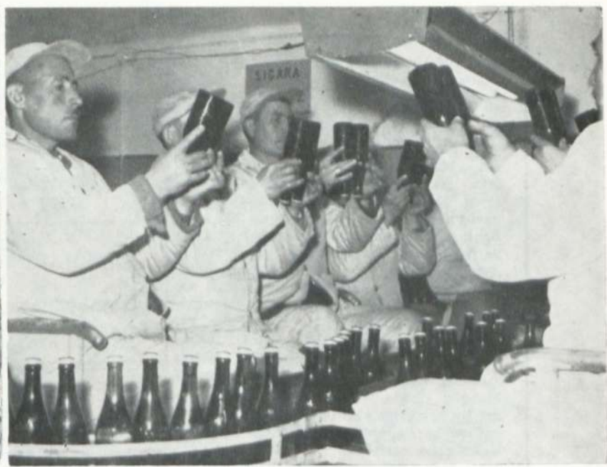
Birinci kontrolden sonra kapsüllenlen şişeler bu defa başaşağı tutularak ışıklara karşı yeniden kontrolden geçirilir.
